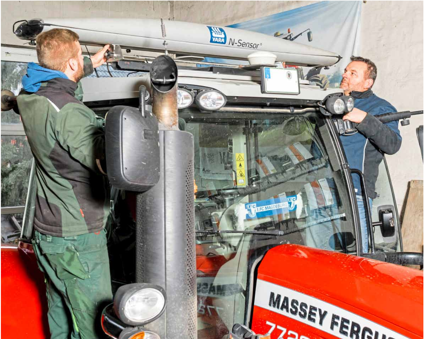
Eric Krull (rechts) und Sohn Moritz installieren den N-Sensor auf ihrem Pflanzenschutzschlepper.
